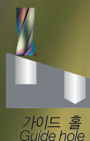
특이한 홀의 교정 Correction of eccentric hole
